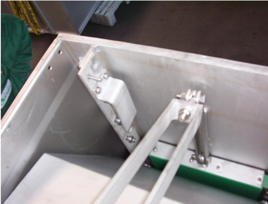
Zulaufseitiger Regelschieber in Arbeitsposition
